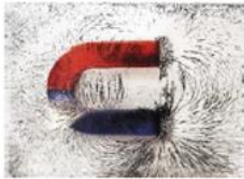
図1 見えない磁界を見る実験 (1例としてU型磁石の磁界の様子を示す)
